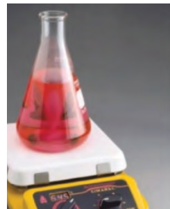
სურათი 3.8. მაგნიტური სარეველა. მორევა წარმოებს მინით ან პოლიმერთი დაფარული მაგნიტის ღეროთი
