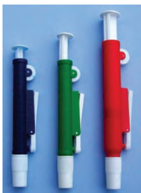
სურათი 2.18. პიპეტებში ნივთიერების ამოსატუმბი მოწყობილობა
