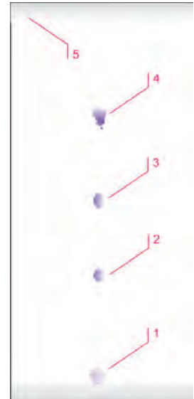
სურათი 3.29. თხელფენოვანი ქრომატოგრაფია: 1-სტარტის ხაზი სუსტად შესამჩნევი ლაქა ან მისი დატანის წერტილი; 2,3,4-კომპონენტების ლაქები; 5- ფრონტის ხაზი
