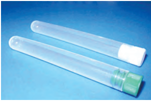
სურათი 2.4. პოლიმერული სინჯარები თავსახურავებით
