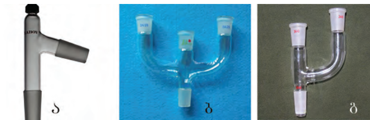
სურათი 2.35. ფორშტოსები (ადაპტორები): ა - კლავიზის, ბ - სამყელა; გ - ორყელა
