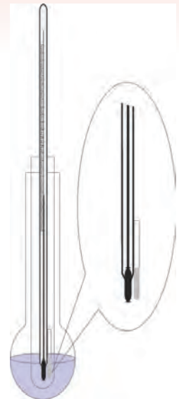
ნახაზი 3.27. ხელსაწყო ლღობის ტემპერატურის განსაზღვრისათვის: 1- მრგვალძირა კოლბა, 2-სინჯარა, 3 თერმომეტრი, 4 კაპილარი საკვლევი ნივთიერებით
