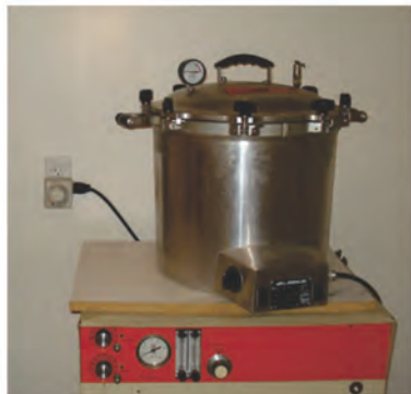
სურათი 3.19. საშუალო ზომის ლაბორატორიული ავტოკლავი (მარცხნივ), ელექტროთერმოსტატი (მარჯვნივ)
