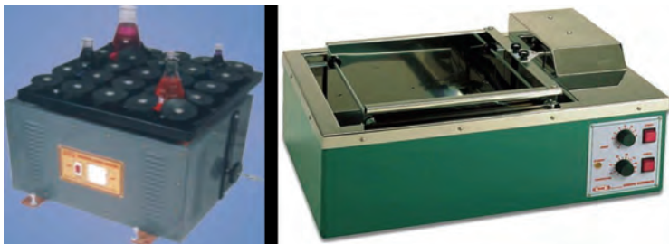
სურათი 2.46. სანჯღრევი აპარატები: თერმოსტატირების გარეშე (მარცხნივ), თერმოსტატირებით (მარჯვნივ) კოლბის გამახურებლები
