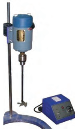
სურათი 3.9. მექანიკური სარეველა. მორევა წარმოებს ელექტროძრავასთან მიერთებული მინის ან უჟანგავი ფოლადის სარეველით
