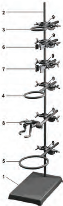
სურათი 2.41. ლაბორატორიული შტატივი: 1 - სადგარი 2 - შტატივის ღერო 3 - მცირე ზომის რგოლი 4 - საშუალო ზომის რგოლი 5 - დიდი ზომის რგოლი 6 - მცირე ზომის თათი 7 - საშუალო ზომის თათი 8 - დიდი ზომის თათი 9 - თათის დამჭერი
