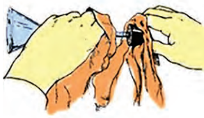
სურათი 1.2. მინის დეტალებზე რეზინის მიღების ჩამოცმის დროს მინის გატეხვის თავიდან აცილების მიზნით აუცილებელია მათი წინასწარ წყლით დასველება, გლიცერინის ან ვაზელინის წასმა და შემაერთებელ ნაწილებზე ორივე ხელის თითების მაქსიმალურად ახლოს გახლაგება
