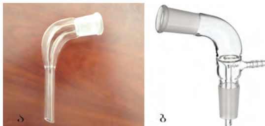
სურათი 2.36. ა - მარტივი გამოხდის ალონჟე, ბ - ვაკუუმგამოხდის ალონჟე
