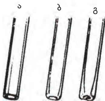
სურათი 3.4. ა - მინის მილი შელლობამდე ბ - მინის მილი შელლობის შემდეგ გ - ზედმეტად გადახურებული მილი
