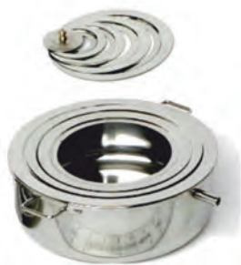
სურათი 3.20. წყლისა და ორთქლის აბაზანა ასაწყობი რგოლებით
