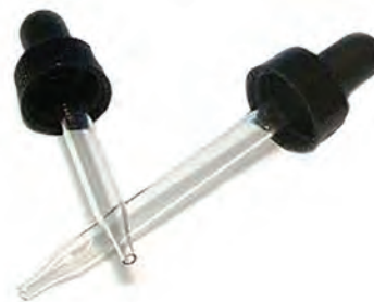
სურათი 2.16. პიპეტი. ნივთიერების წვეთობით დამატებისას გამოიყენება პიპეტი
