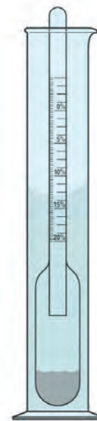
სურათი 3.24. არეომეტრით სიმკვრივის განსაზღვრა
